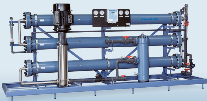
RO C3 - flödes hastighet upp till 45 m 3 /h Tryckbehållare av stål belagd med polyeten. Tre 8" membran i varje tryckbehållare.
