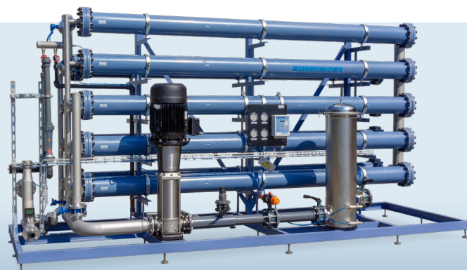
RO C4 - flödes hastighet upp till 60 m 3 /h Tryckbehållare av stål belagd med polyeten. Fyra 8" membran i varje tryckbehållare.
