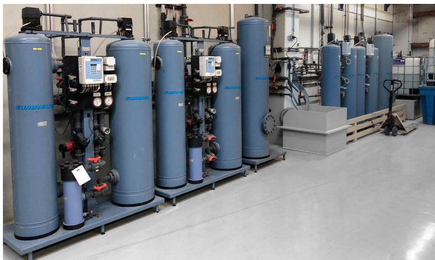
Dubbla avjoniseringslinjer till förbehandling av lättmetallfälgar.
