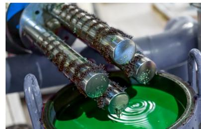
Un insert magnétique dans le filtre à particules collecte les résidus du circuit.
