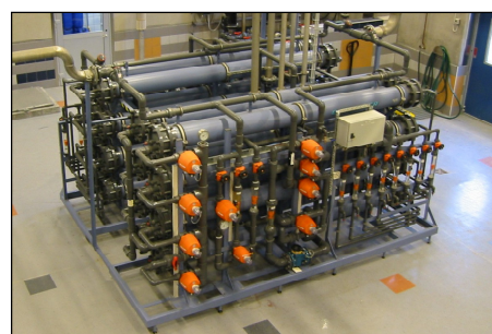
Drikkevandsinstallation fra Sverige på 48 m 3 /h. Løsningen består af 2 x NF 03-24, forfilter og fuldautomatisk renseenhed. Applikation: Blødgøring af grundvand.
